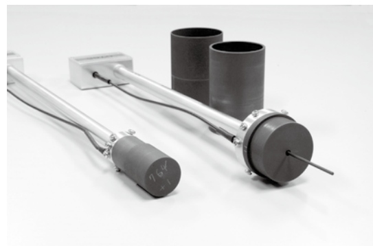
Fig. 3 グラファイト壁空洞電離箱
