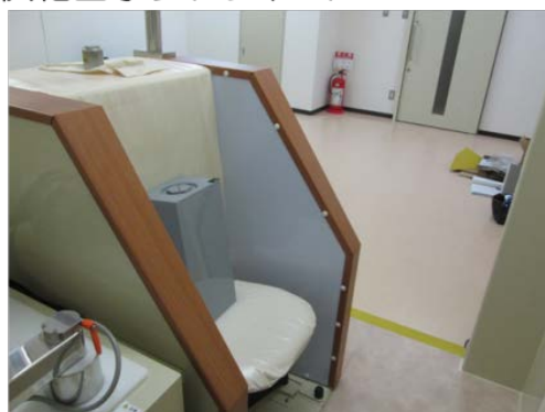
別図 8 バックグラウンド用水ブロックファントム
