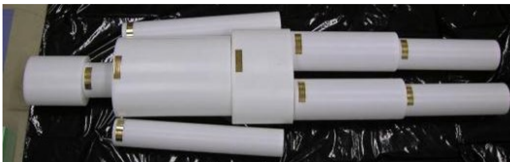
図 4 福島県内の WBC 精度調査に使用した放医研ファントムの外観
