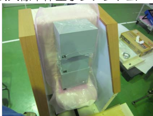
別図 8 バックグラウンド用水ブロックファントム
