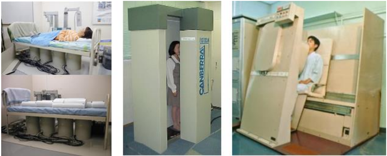
図 9 福島県住民の測定に使用された WBC の外観
