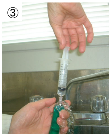
③ チューブを上向きにして，注射針を試料水に入れてサンプリング
