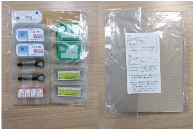
図 4.2.2.3 試験時の受動形個人線量計の荷姿の一例（左：オモテ面、右：ウラ面）
