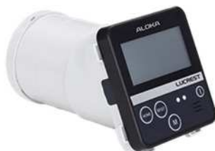
図 4.1.2.6 試験に使用した電離箱 4-9)
