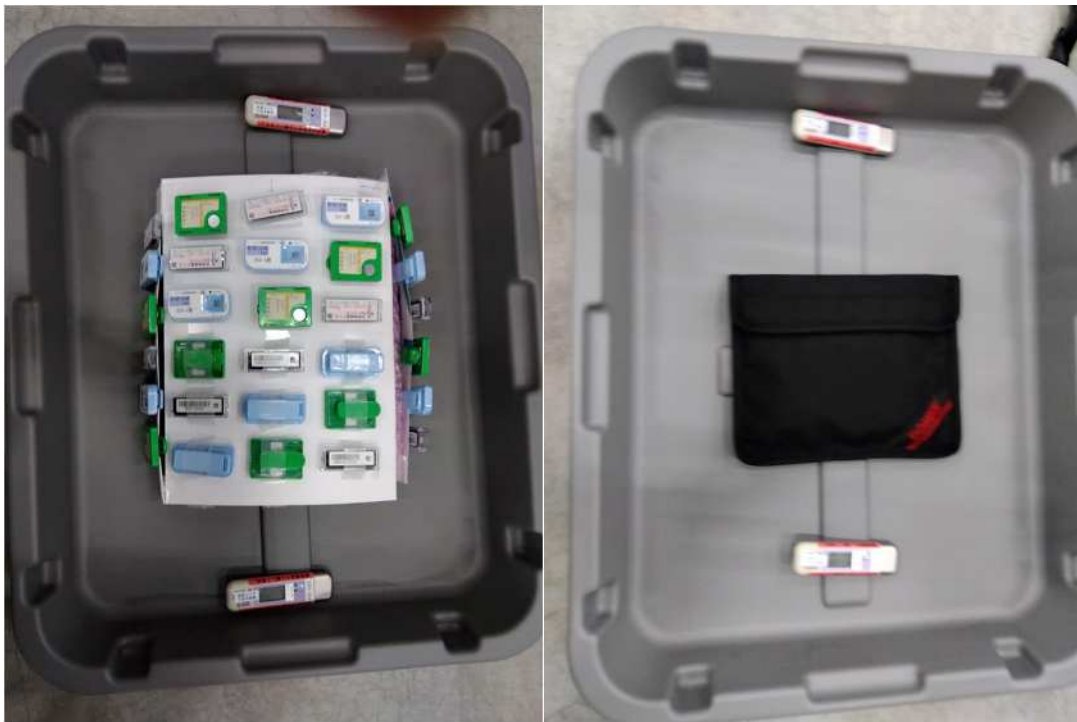
図 4.1.2.14 従来型手荷物検査装置における試験時の荷姿 (左：Gr.1、右：Gr.2)
