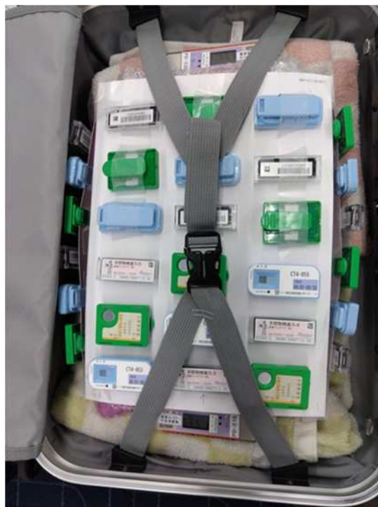
図 4.1.2.13 CT型手荷物検査装置における試験時の荷姿（Gr.6）
