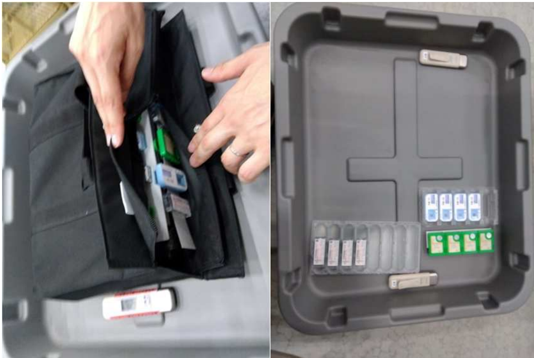
図 4.1.2.16 従来型手荷物検査装置における試験時の荷姿 (左 : Gr.3、右 : Gr.4)
