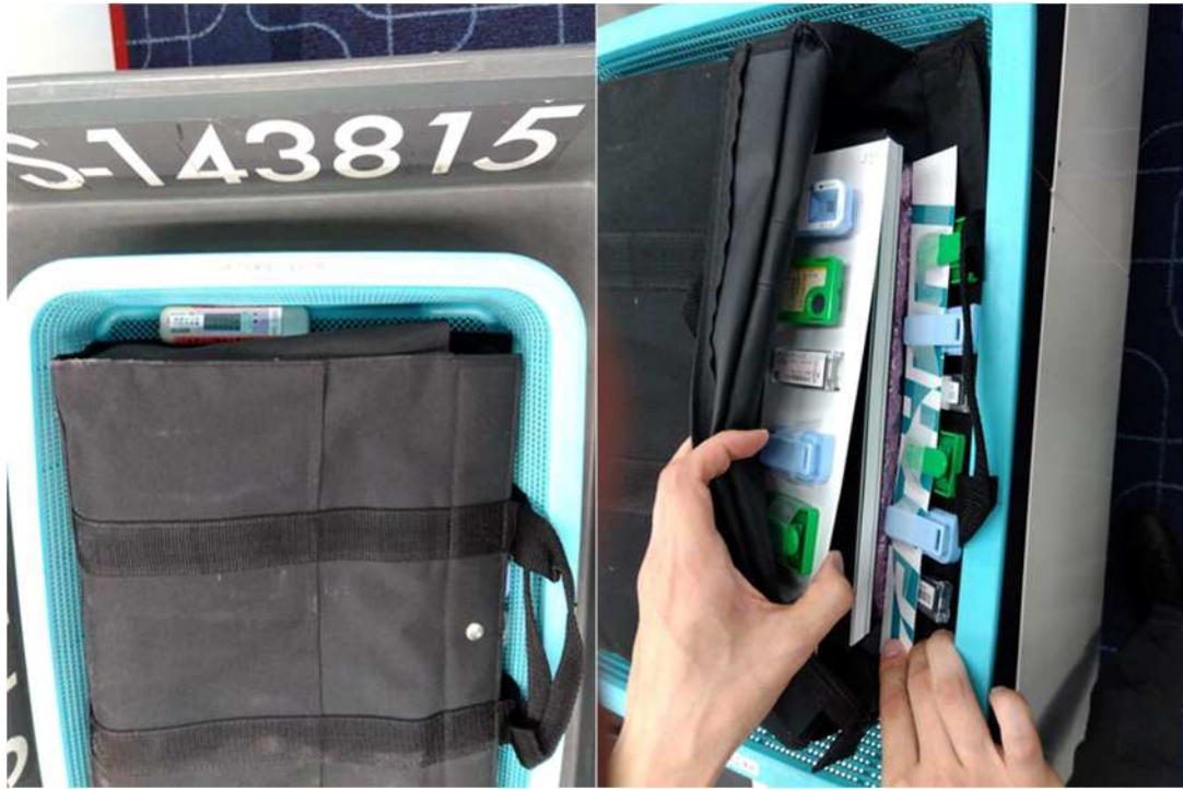
図 4.1.2.12 CT型手荷物検査装置における試験時の荷姿（左：Gr.4, Gr.5、右：Gr.5）
