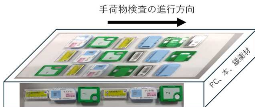
図 4.1.2.2 ノートパソコン等に受動形個人線量計を貼り付けた様子
