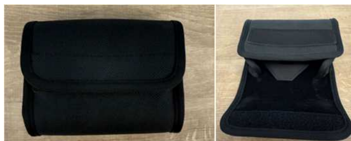
図 4.1.2.9 試験に使用した X 線遮へい袋② 4-13)
