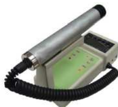
図 4.1.2.7 試験に使用した NaI サーベイメータ 4-10)
