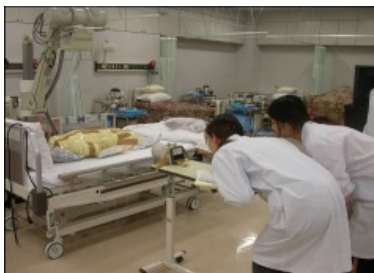
ポータブルX線装置を用いて、一般病室で撮影を行う際の散乱線の測定
